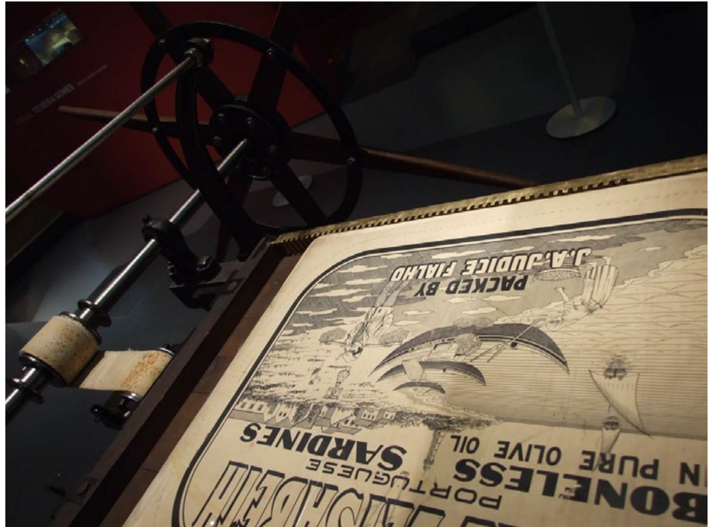
Die lithographische Druckpresse zum Bedrucken von Konservenbleche steht an ihrem Stammpatz. Die Sammlung des Museums in Portimão besteht aus Industrie- und ethnographischem Erbe, insbesondere der Konservenindustrie, des Schiffbaus, der Fischerei, Stauerei, Lithographie und Verpackung.
